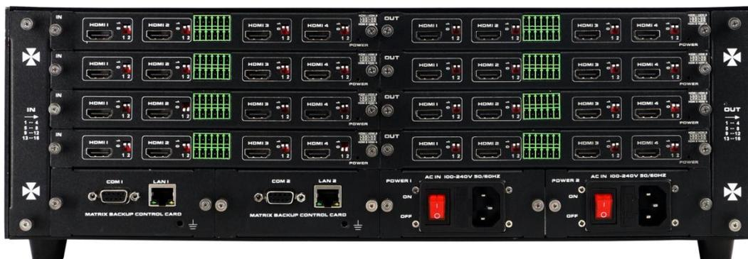
**散熱風扇**：可拆卸,更換散熱風扇 / **插槽**：可插入一卡四埠板卡, 輸入區 支援 DVI、HDMI、VGA、CVBS、YPbPr、FIBER、HDBaseT 輸入, 輸出區 支援 DVI、HDMI、VGA、CVBS、YPbPr、FIBER、HDBaseT 輸出 / **狀態指示燈**：當板卡連接到電源時 STATUS 指示燈為常亮狀態 / **鳳凰端子**：音訊輸入輸出 / **LAN 控制介面**：雙網路控制介面, 支援遠距網路控制 / **RS232 控制介面**：雙串口控制, 透過 RS232 線連接控制 / **電源輸入**：AC 220V-240V 50/60Hz / **電源開關**
