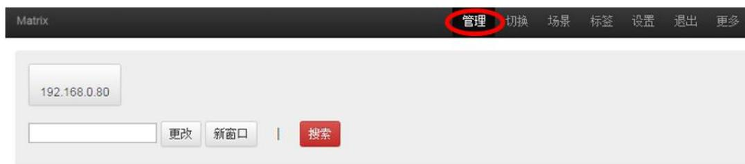
按一下“管理”選項，能實現多台矩陣的集中控制。在同一個區網中，可同時控制多台同一網段不同 IP 地址的矩陣，最多可以同時控制 254 台矩陣。如下圖連入
