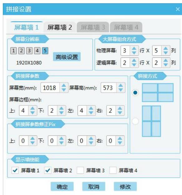
拼接管理主要的功能为设置拼接墙规模，选择相应的物理屏行和物理屏列，点击应用屏幕墙就会改变成相应的拼接规格，点击确认设置即可完成对拼接规格的修改。点击取消按钮设置不生效，点击同步按钮，可以同步当前屏幕墙的拼接信息，显示墙使能，是设置屏幕模拟区显示的屏幕墙，选中则显示，否则为不显示，屏幕墙不可用。
