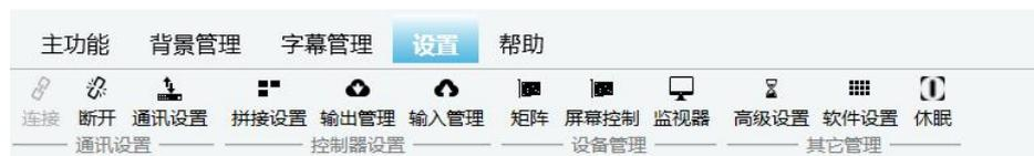
点击通讯连接按钮，系统第一次运行时将采用默认的通讯设置进行连接，默认的通讯设置假如不能正确的连接设备，请进入通讯设置功能页进行相关设置。通讯设置页面如图 2.5 所示。
