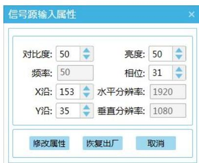
图像信号调整提供的操作包括图像质量调整，图像信号调整部分提供对比度，亮度，频率，相位，x 沿、y 沿以及分辨率的调整，在相应的输入框中输入实际数据，点击修改属性，保存数据，更改图像的质量，点击恢复出厂，则恢复出厂设置。
