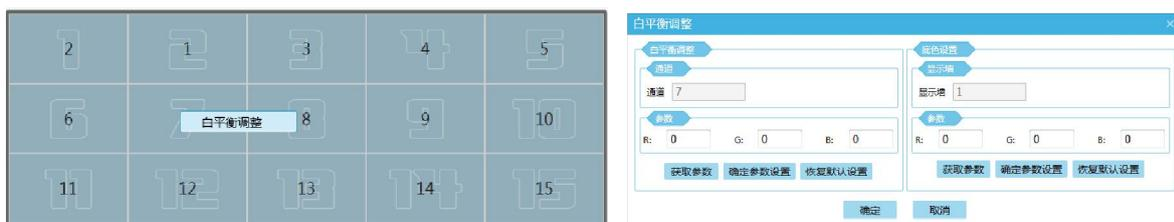
白平衡调整：点击“获取参数”按钮，则获取指定通道的参数；输入相应的参数点击“确定参数设置”按钮，即可调整显示通道参数，点击“恢复默认参数设置”按钮，则参数恢复到初始默认参数设置。
