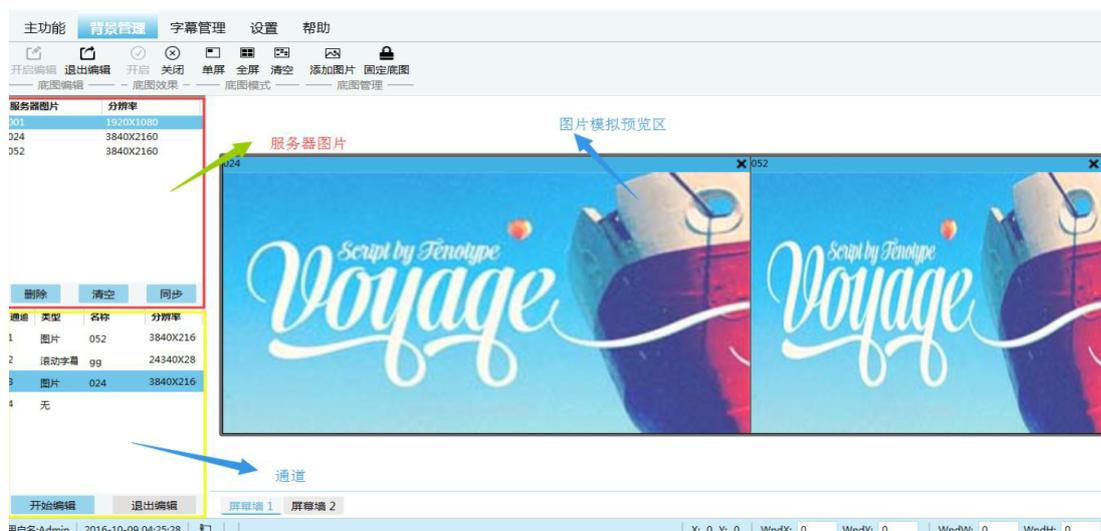
在服务器图片管理列表中，显示图像的名称和图像的分辨率；选中图片，点击删除按钮，就删除服务器上和软件中选中的底图，点击清空按钮，清空服务器和控制软件上的所有底图；点击同步按钮，同步服务器的底图。底图编辑区，显示图片通道号、类型、名称以及分辨率，默认是不能编辑，点击开始编辑按钮进入通道编辑功能，选中通道，点击通道的类型即弹出下拉框，选择通道类型，如下图所示
