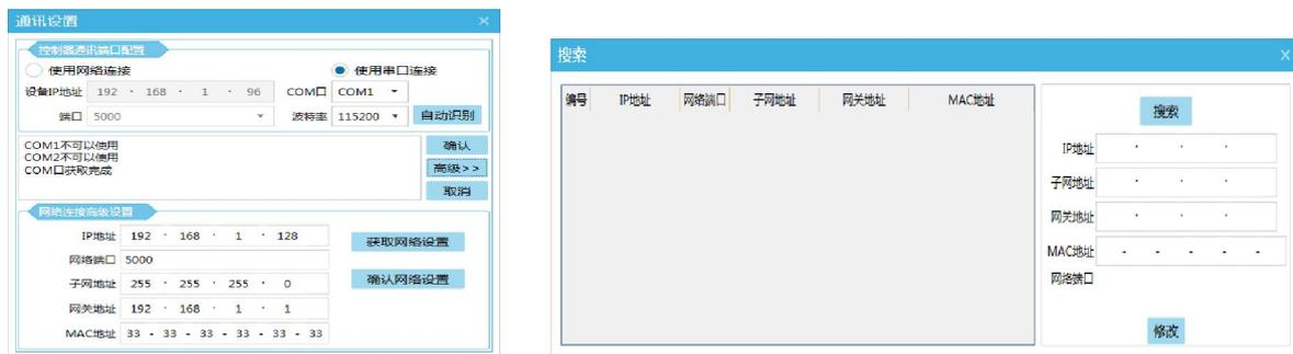
要设置控制器的 IP 和端口，用户需要在对应的输入框中，输入实际的值，点击确认网络设置，即进行网络设置和保存参数。
